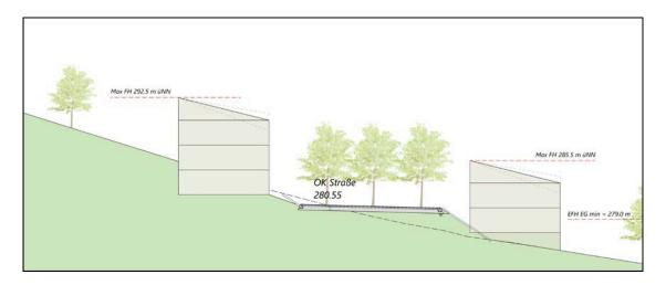
Querschnitt im Bereich der Wendeanlage – Gebäude mit Pultdächern, Stand: 12.12.2018, schreiberplan, Stuttgart
